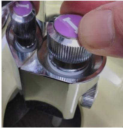
Fig.6. 気化器使用前の内圧抜き(1秒間だけ開閉)
