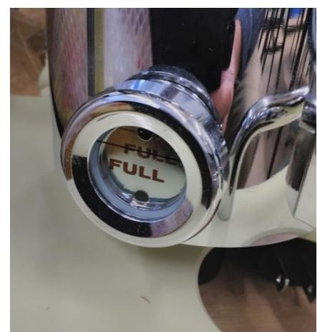
Fig.5. 気化器薬液量の確認小窓
